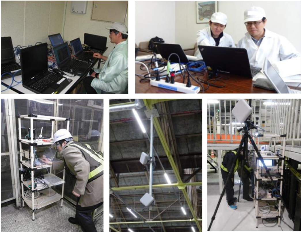
図 1 NICT と共同実験各社が、複数の稼働中の工場で行った無線環境評価、無線通信実験の様子 使用している周波数は、920MHz 帯、2.4GHz 帯、5GHz 帯、60GHz 帯
